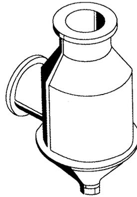
• **Поз. 5** - Проходной элемент через перекрытие - Кровельный вывод
