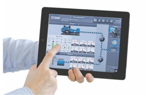
Технология позволяет непосредственно на изделии делать снимки экрана и видеозаписи, которые могут быть сохранены на переносной памяти и затем пересланы по электронной почте (диагностика, техническое обслуживание, сохранение данных, обучение, документация, коммерческая поддержка).
